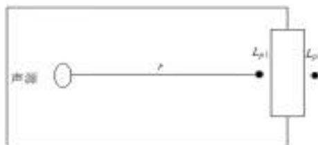
图 7-1 室内声源等效为室外声源图例
